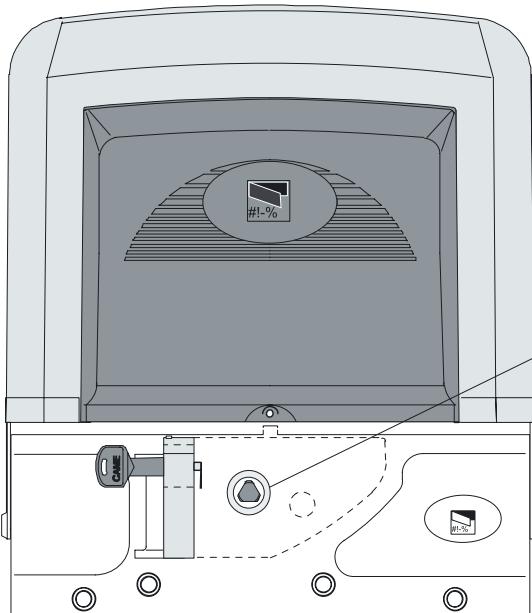
Trojhranným klíčem otevřete dvírka pro uvolnění pohonu (otočte klíčem proti směru hod. ručiček o čtvrt otáčky, během toho poněkud na klíč zatlačte). Vložte černý klíč do otvoru dle obr. Klíčem otočte proti směru hod. ručiček, dokud neuslyšíte zvuk západky. Brána je nyní uvolněna. Pro návrat pohonu do normálního stavu
